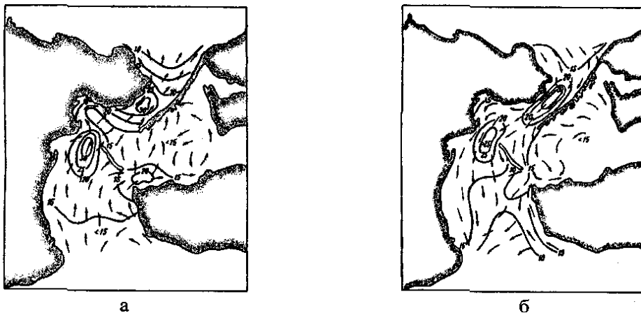
Рис. 1 - Типовые схемы циркуляции вод в Керченском проливе до строительства дамбы по Э.Альтману [1], основанные на эмпирических данных: а – черноморский поток, б – азовский поток.
