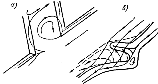
Рис. 1 - Циркуляція на вході в канал: а) плоскі вирі; б) тривимірні вирі
