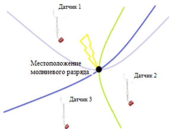
Рис. 2 - Метод локації молний на основі принципу «времени прихода сигнала»
