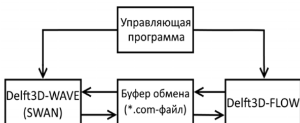
Рис. 1 – Схема работы комплекса интегрированных моделей Delft3D-FLOW + SWAN
