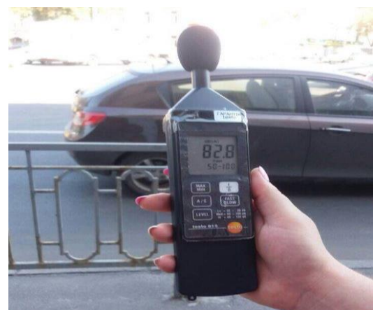
Рис. 4 – Шумомір марки Testo 815
